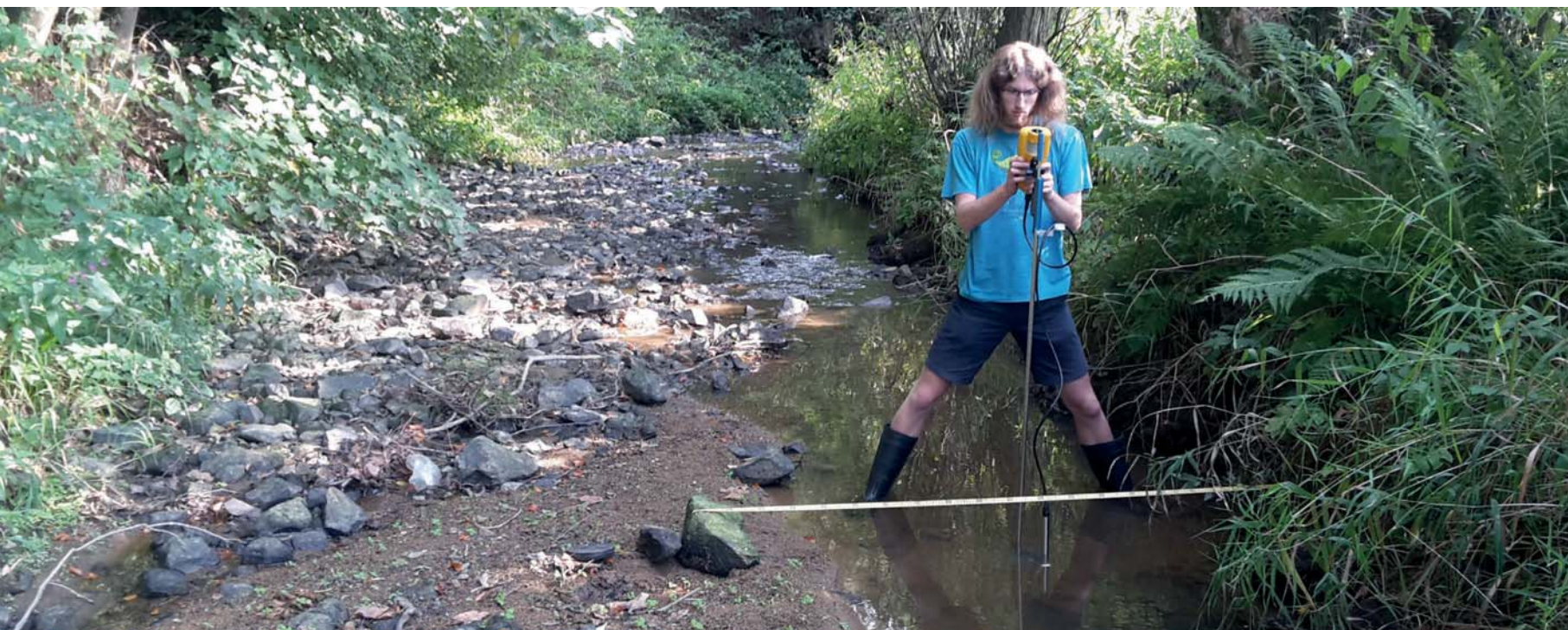
Foto 6.1 Měření velmi malého průtoku na Borovském potoce ve Stříbrných Horách dne 28. srpna 2018 přístrojem FlowTracker (foto Tomáš Fryč).
