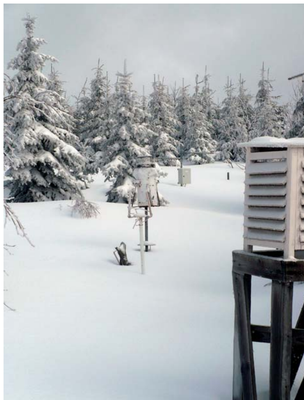
Obr. 1 Manuální a automatické měření teplot a srážek na VP Jizerka v roce 2010 (foto: O. Špulák).
