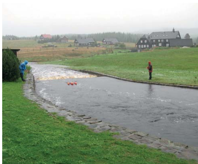
Obr. 6 Přetahování ADCP člunu při měření povodňového průtoků ( 8,9 \text{ m}^3 \cdot \text{s}^{-1} ) v profilu Jizerka, 7. 8. 2010.
