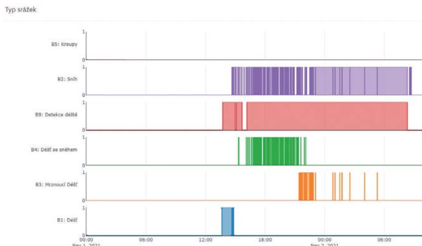
Obr. 3 Grafické zobrazení detekce typu srážek během studené fronty 1. 11. 2021.
