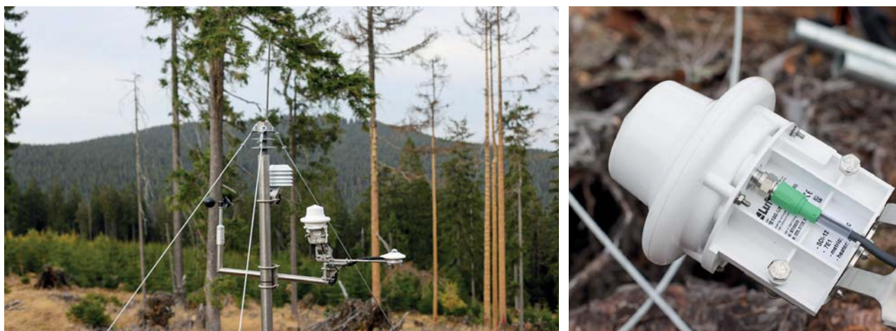
Obr. 1 Pohled na instalaci radarového srážkoměru a detail samotného senzoru.
