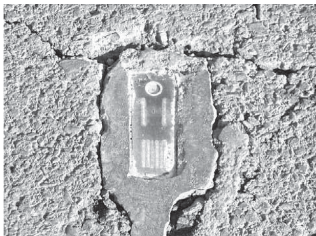
Obr. 3 Silniční senzor Vaisala s vybavením pro měření elektrochemických vlastností solného roztoku, výška vodního filmu měřena opticky v infračerveném oboru spektra.
