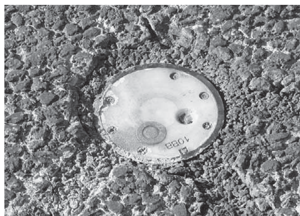
Obr. 4 Silniční senzor Lufft s vybavením pro měření elektrochemických vlastností solného roztoku, výška vodního filmu měřena miniaturním radarem.
