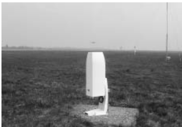
Obr. 4 Ceilometr CT 25K na letišti Ostrava-Mošnov.
