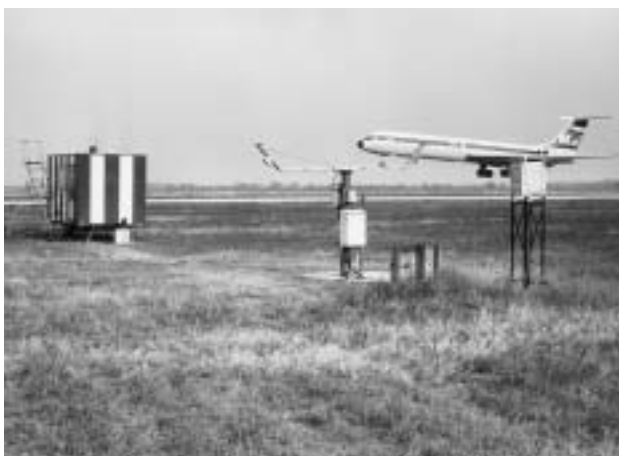
Obr. 2 Automatizovaný meteorologický systém IVR–MET anglické firmy MARCONI na letišti Bratislava-Ivanka v 80. letech minulého století. Foto Z. Kmentová.
