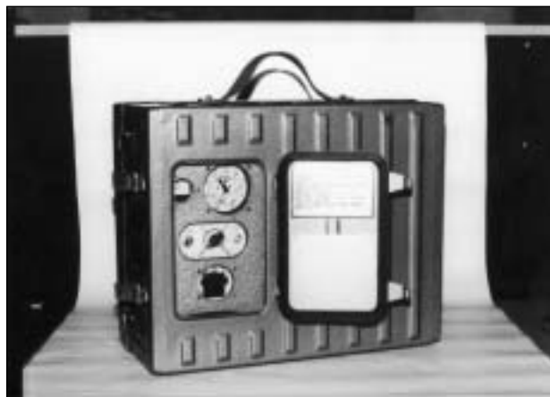
Obr. 6 Přenosná meteorologická stanice PMK (měřící čidla pro teplotu, tlak a vlhkost vzduchu, směr a rychlost větru). Touto stanicí jsou rovněž vybaveny jednotky pozemního vojska AČR.
