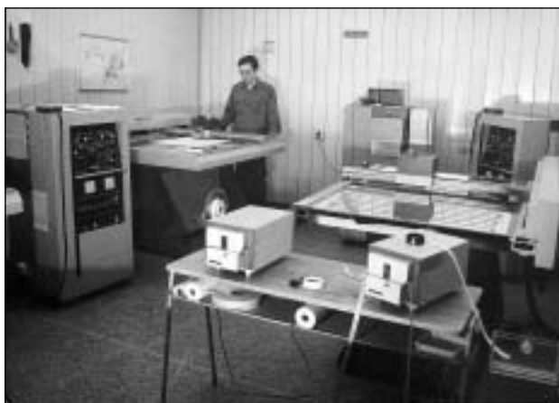
Obr. 8 Pracoviště automatického zákresu meteorologických materiálů u HPÚ z roku 1973. Je vybaveno počítači ADT 4300 a kreslicími stroji DIGIGRAF. Systém byl zaveden do provozu v roce 1973 a průběžně modernizován.
