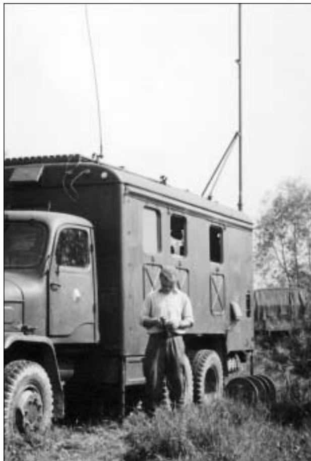
Obr. 2 V polních podmínkách rozvinutá mobilní povětrnostní stanice LPS-65 počátkem sedmdesátých let. Obdobně byla řešena zástavba radiosondodázní stanice pro letectvo, PVO a RVD.
