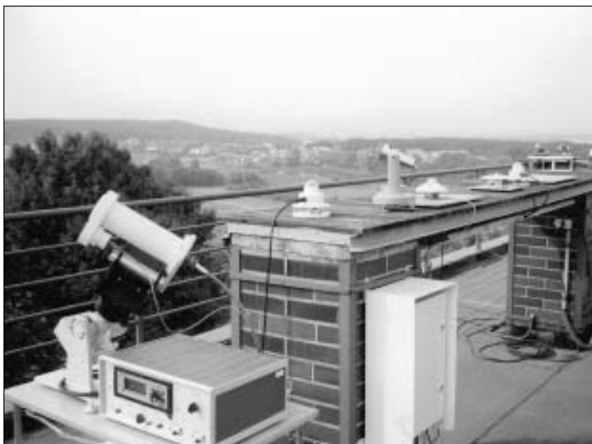
Obr. 2 Přístroje na měření ozonu a slunečního záření na SOO-HK.
