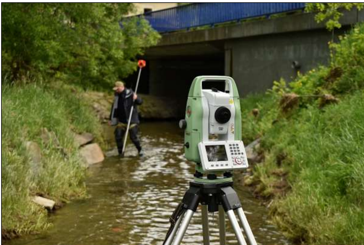
Obrázek 12 Geodetická měření v okolí stanice Jakartovice po proběhlé povodni.
